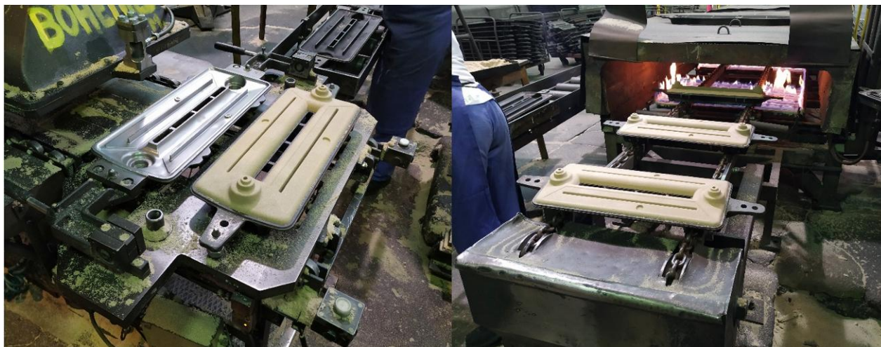
Obr. 23, 24. Vlevo sklopené jádro; vpravo položená sušící podložka s jádrem na řetězový dopravník pece
