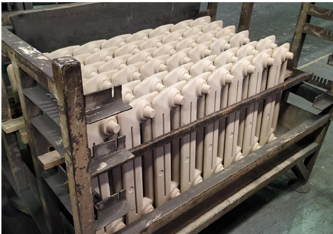
Obr. 27. Uložená jádra v transportním koši zajištěná profilem
