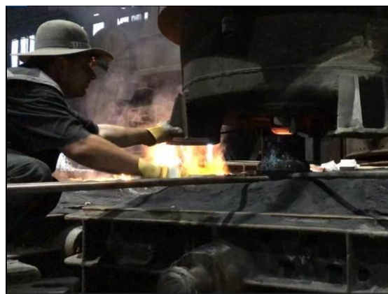
Obr. 8b. Pánev nad shroudem před spojením a utěsněním pootočením zdvihacího zařízení
