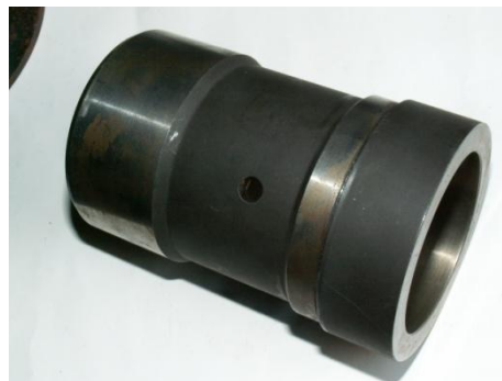
Obr. 3. Odlitek z ADI, hmotnost 0,6 kg
