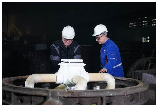
Obr. 5a. Sestavení filtrační komůrky a vtokové soustavy
