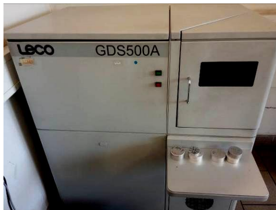
Obr. 7. Spektrální analyzátor (doutnavý výboj)
