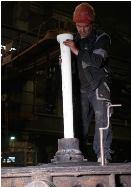
Obr. 6a. Instalace shroudu do složené formy
