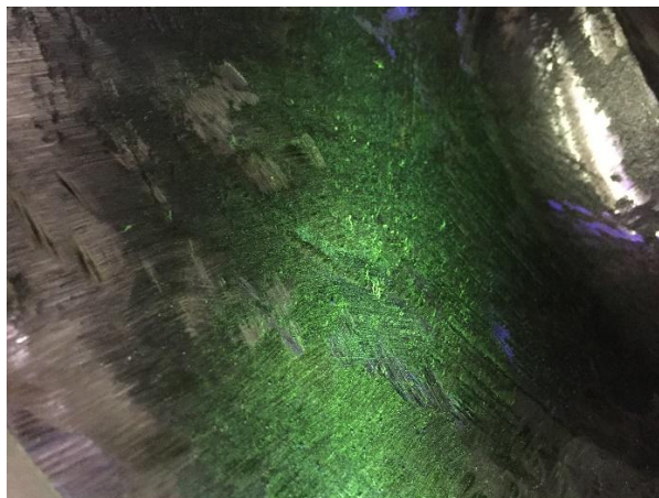
Obr. 11b. Povrch při lití kónickým shroudem se zmenšeným průměrem výstupního otvoru
