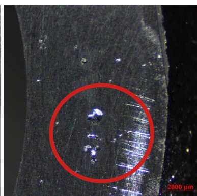
Obr. 11. Staženiny viditelné na snímku RTG a dále zobrazené na makrovýbrusu
