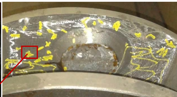
Obr. 10b. Povrch odlitku litého klasickou technologií
