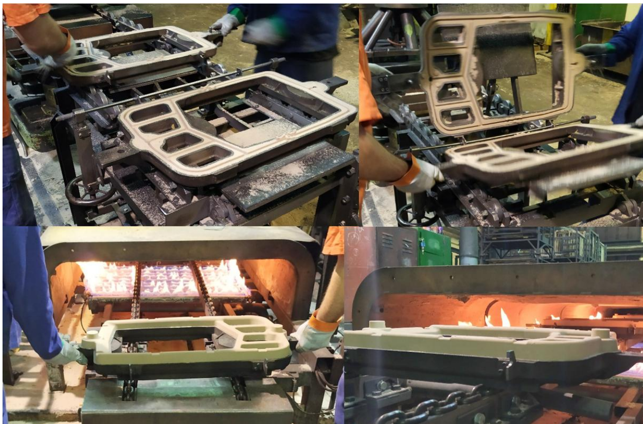
Obr. 10, 11, 12, 13. Ruční sklapaní kotlových jader a položení sušicích podložky na řetězový dopravník pece
