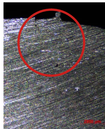
Obr. 10. Bublina nezasahuje do odlitku pod stereolupou jsou patrné mikrostaženiny u vtoku
