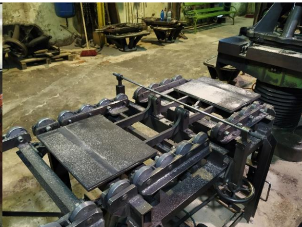
Obr. 8, 9. Vlevo válečkový dopravník s nahřátými sušícími podložkami; vpravo sklapovadlo
