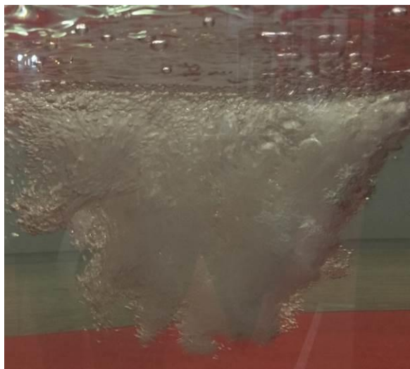
Obr. 2d. Vodní model simulace přelévání kovu
