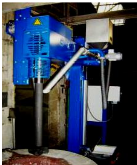
Obr. 9. Odplyňovací zařízení FDU s násypkami na modifikační a očkovací granulát
