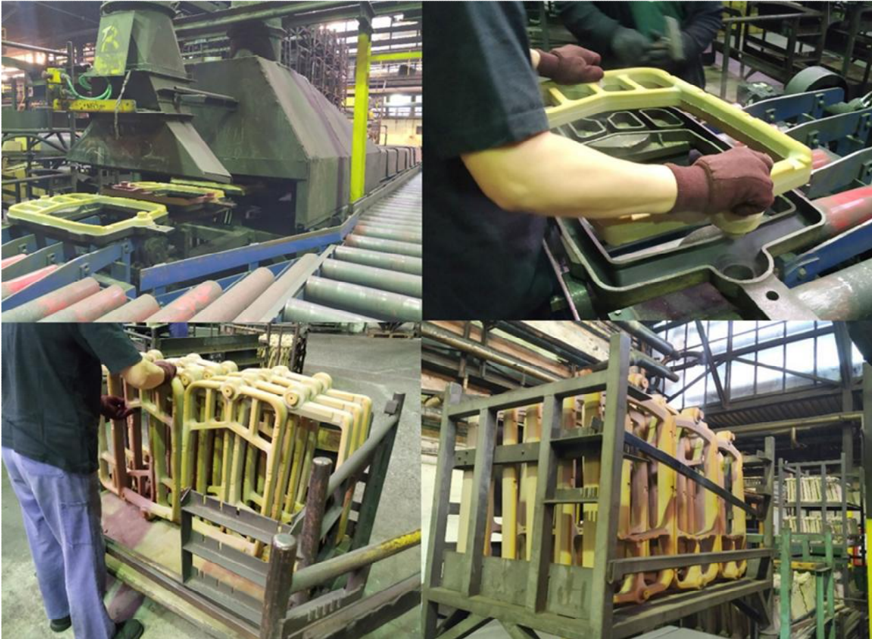
Obr. 14, 15, 16, 17. Vytvrzené a očištěné jádro se uloží do transportního koše
