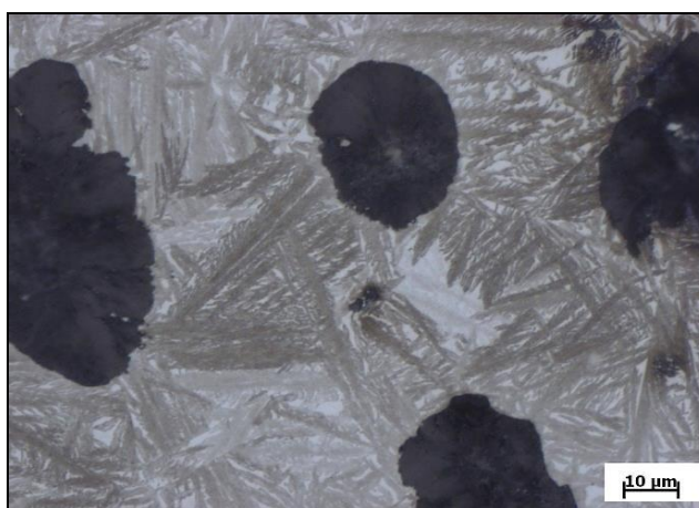
Obr. 6. Typická struktura ADI: 900 °C/60 min.; solná lázeň: 350 °C/60 min.; dochlazení ve vodě Austenit světlý, ferit- laťky tmavý [6]
