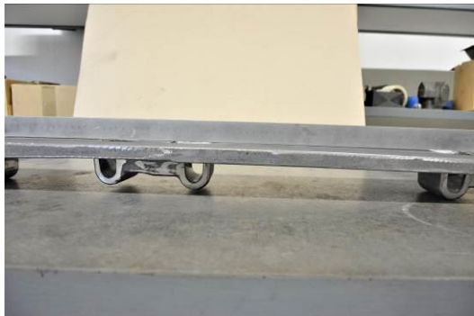
Obr. 13. Rovinnost plotny v toleranci 1mm
