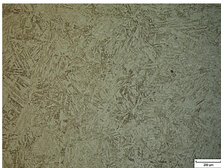
Obr. 7. Mikrostruktura oceli při Ni_{ekv. 5,01} po kalení a popuštění, kalení proudícím vzduchem s vodní mlhou
