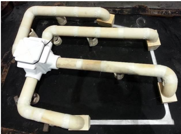
Obr. 16a. Sestavená vtoková soustava s filtrační komůrkou
