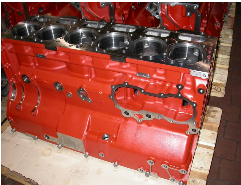
Obr. 1. Obrobený blok válců připravený k montáži motoru
