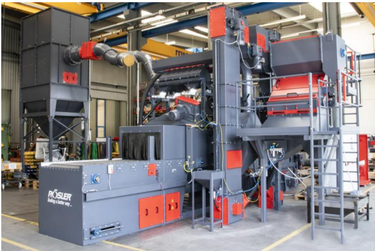
Obr. 1. Průběžné tryskací zařízení Rösler s drátěným pásem RDGE 1250-4-F
