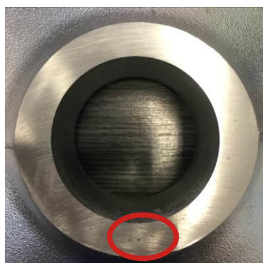
Obr. 11. Staženiny viditelné na snímku RTG a dále zobrazené na makrovýbrusu
