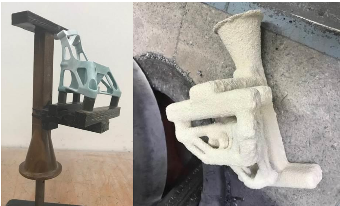
Obr. 10. Příprava stroměčku a výroba keramické skořepiny
