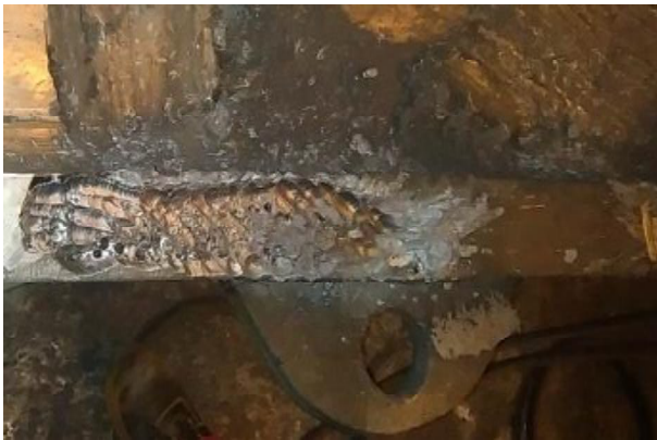
Obr. 15a. Bubliny a plynové kanálky ve vršku odlitku
