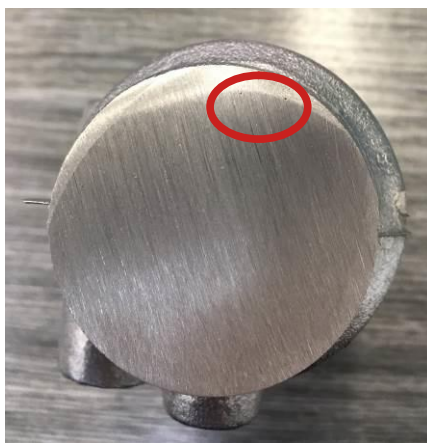
Obr. 10. Bublina nezasahuje do odlitku pod stereolupou jsou patrné mikrostaženiny u vtoku
