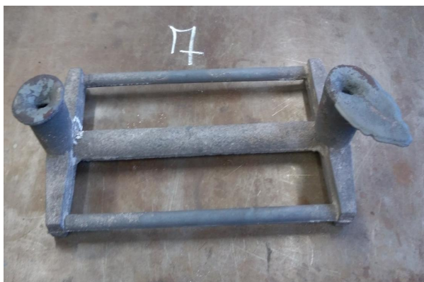
Obr. 2. Zkušební odlitek litinové mříže s trhlinou a její detail pod nálitkem
