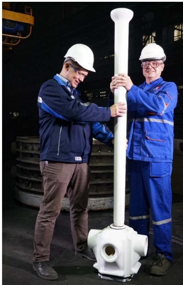
Obr. 4b. Instalace shroudu do filtrační komůrky
