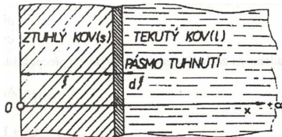
Obr. 1. Tuhnutí polonekonečného odlitku podle Neumanna
