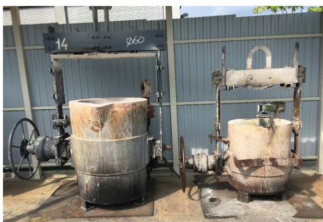
Obr. 1. Licí pánve se spodní výpustí 1,2 t a 0,5 t
