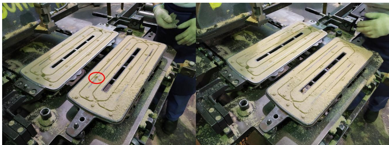
Obr. 22. Vlevo nedostřelené jádro; vpravo zasypané jádro připraveno na sklopení
