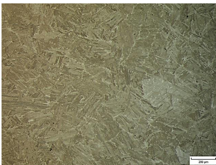
Obr. 5. Mikrostruktura oceli při Ni_{ekv. 5,01} po kalení a popuštění, kalení na klidném vzduchu
