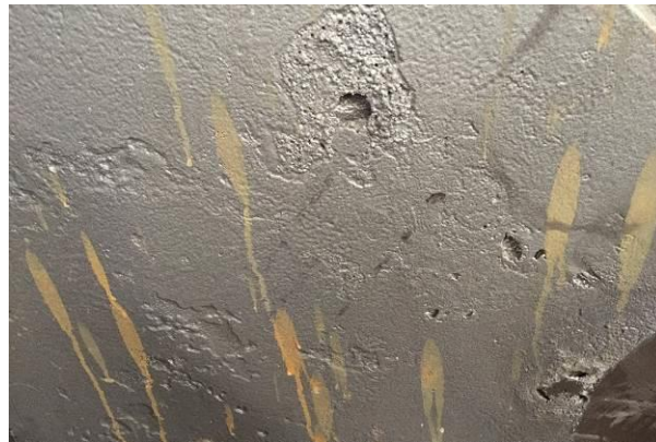
Obr. 15b. Písek a vměstky ve vršku odlitku
