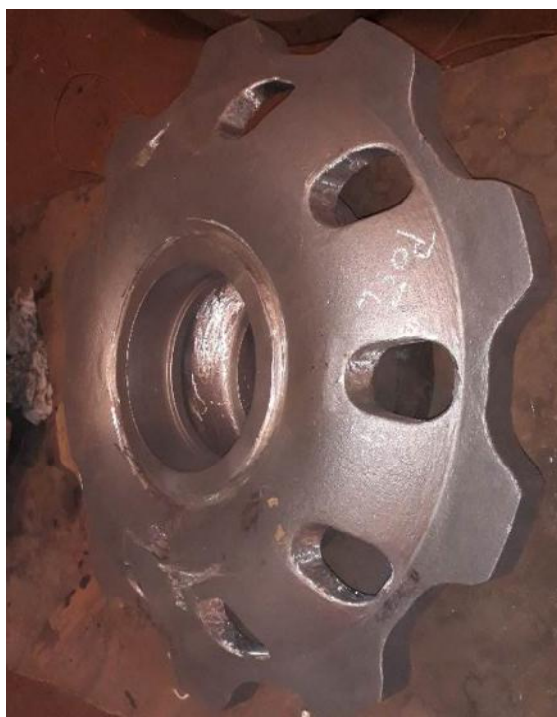
Obr. 12c. zkouška MPI po TZ vyhověla
