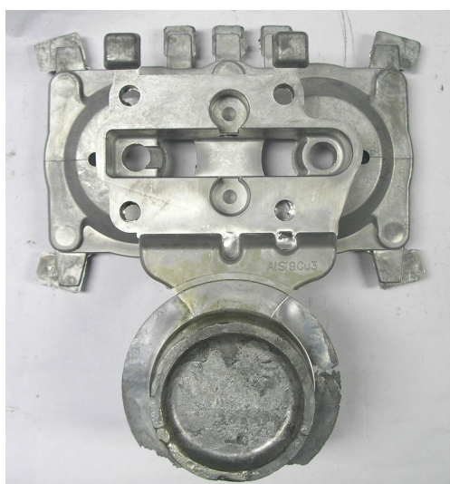
Obr. 4. Původní design odlitku včetně vtokové soustavy pro vysokotlaké odlévání
