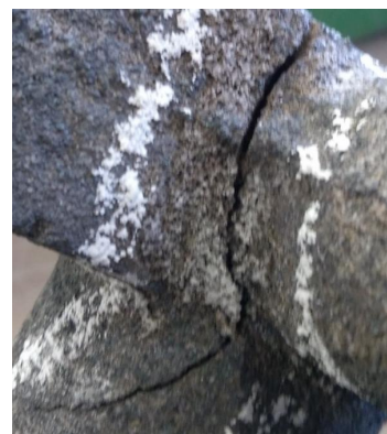
Obr. 2. Zkušební odlitek litinové mříže s trhlinou a její detail pod nálitkem
