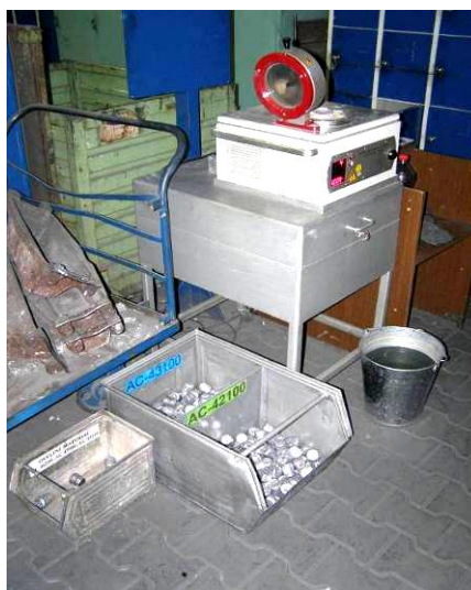
Obr. 10. Podtlaková vývěva pro vzorky na měření indexu hustoty (DI) po zjištění naplynění taveniny (VAC test)
