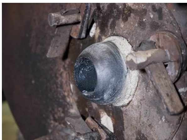
Obr. 9b. Výlevka instalována v pánvi a připravená k lití
