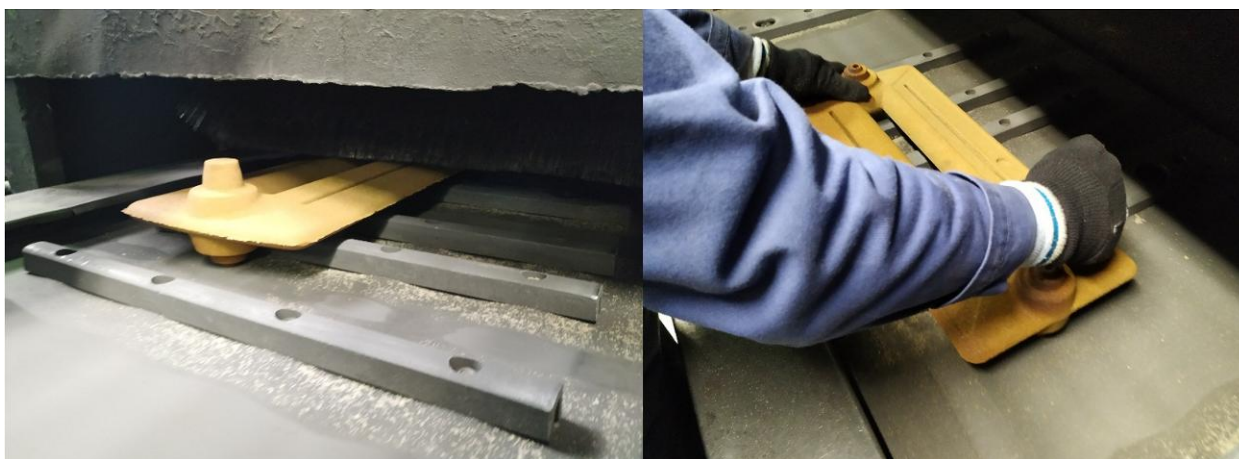
Obr. 25, 26. Vlevo vyjíždí jádro zpoza čistícího zařízení; vpravo ruční dočištění jádra
