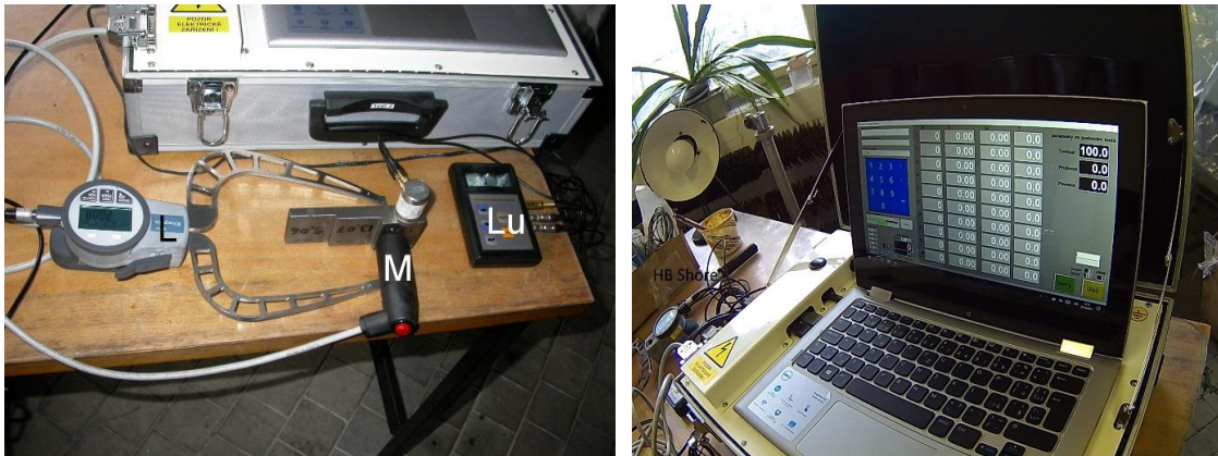
Obr. 3. Strukturoskop TELIT 3 se snímači hodnot L , L_u , M a HB
