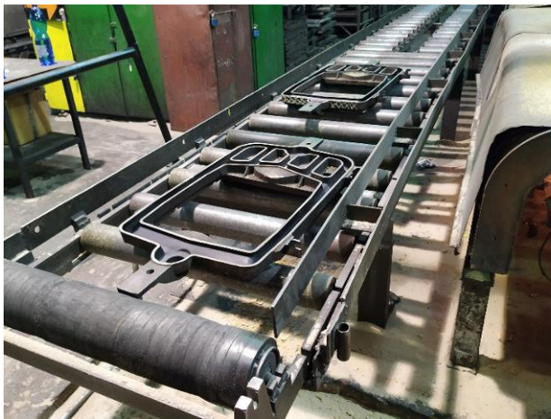
Obr. 8, 9. Vlevo válečkový dopravník s nahřátými sušícími podložkami; vpravo sklapovadlo
