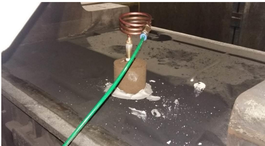
Obr. 4. Umístění chladiče na formě
