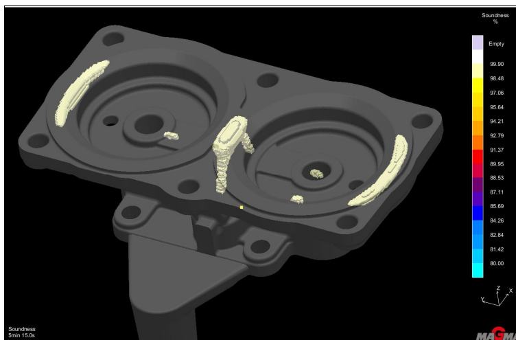
Obr. 8. Výsledek kritéria Soundness s jasně viditelnými staženinami
