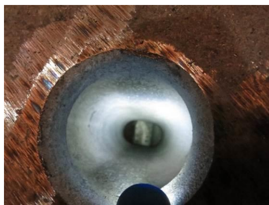
Obr. 2. Povrchová kvalita odlitků od jader, standardní výroba
