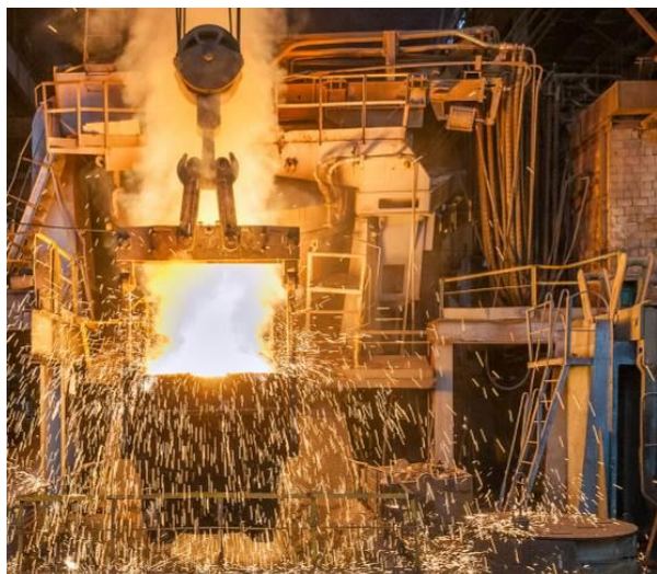
Obr. 2c. Zahlčení plynu a formace bifilmů během odpichu
